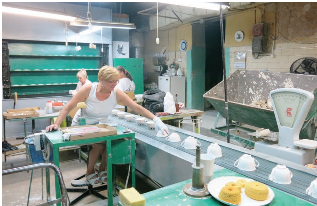
Slika 6: Proizvodna linija: delo z rokavicami, pomočnimi v kobaltovo sol. Tovarna porcelana v Čmielówu, 2016 (foto Ewa Klekot).
