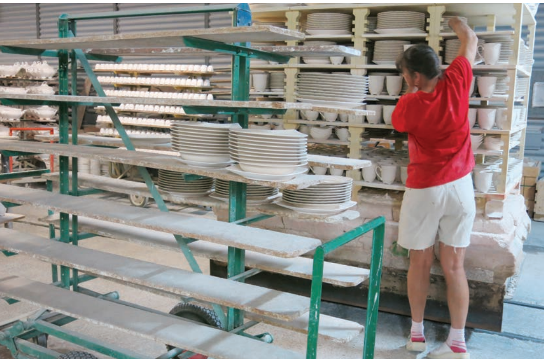
Slika 4: Nalaganje vozička za biskvitno žganje. Tovarna porcelana v Čmielówu, 2016 (foto Ewa Klekot).
